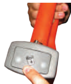
в) Установить батарейный отсек в корпус, надавить на отсек до срабатывания фиксатора
